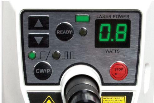
STAND-BY, CW Mode 0.8W (default) output
